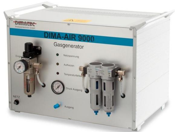
Der DIMA-AIR 9000 bereitet gewöhnliche Druckluft zu CO<sub>2</sub>- und KW-freier synthetischer Luft auf, die als Spül- oder Trägergas für Analysengeräte verwendet werden kann. Werden auch Sie unabhängig von Flaschengas!
